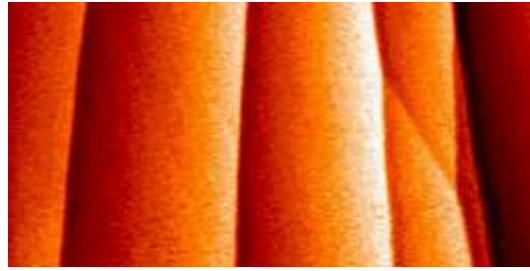
FIG. 5.2 – Image AFM Non-Contact (2000x1000) nm 2 de Al 2 O 3 (0001) utilisée pour l'étude de résonance. \Delta f_c = -30 Hz.
