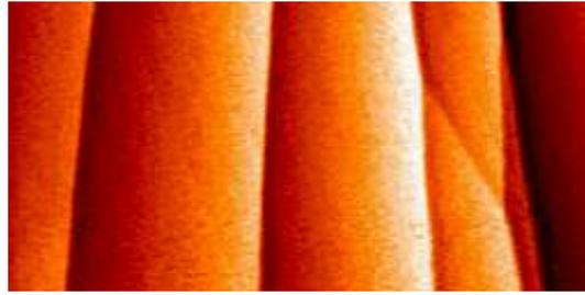
FIG. 5.2 – Image AFM Non-Contact ( $2000 \times 1000$ ) nm<sup>2</sup> de Al<sub>2</sub>O<sub>3</sub>(0001) utilisée pour l'étude de résonance.  $\Delta f_c = -30$ Hz.
