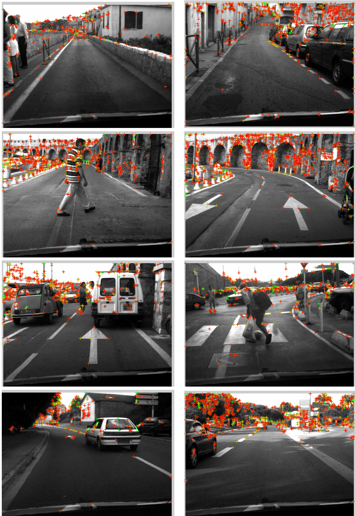
FIG. 4.13 – Résultats de l'extraction de points d'intérêt avec un filtre de Harris et le score de Benhimane. Les points d'intérêt sont classés en fonction de leur score : entre [100,300] en rouge, entre [300,700] en orange, au-delà en vert.
