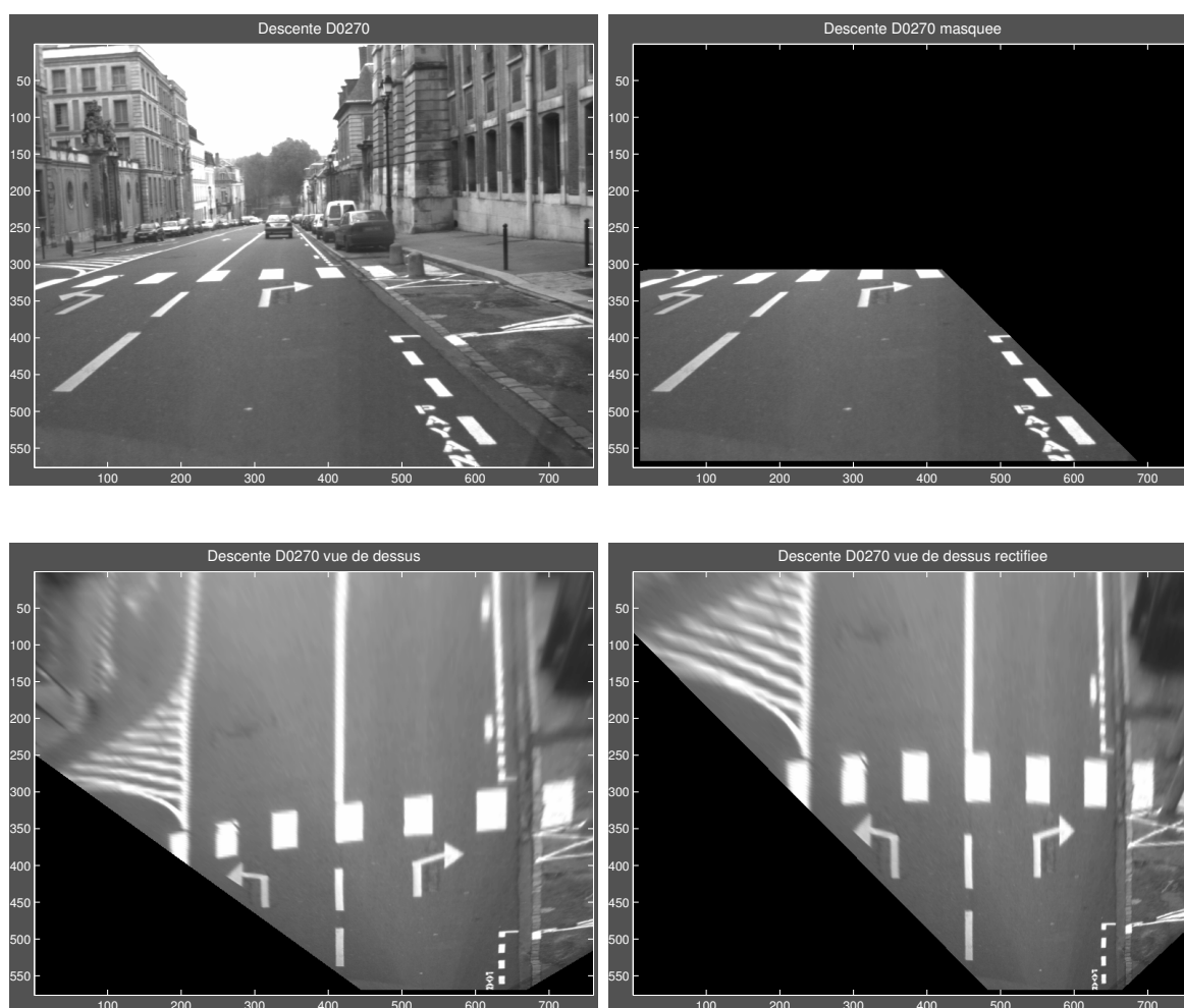
FIG. 6.10 – Choix de la première image pour reconstituer le plan de la route au long de la séquence. L'homographie qui permet de passer du repère caméra à un repère virtuel en vue de dessus nécessite que la ROI contienne des informations relatives à la direction orthogonale à celle de la route de façon à compenser l'orientation du véhicule. L'estimation de l'homographie qui permet une telle transformation est obtenue par composition de l'homographie qui transforme le parallélogramme de la ROI en un rectangle puis par une rectification qui aligne les bandes du passage piéton.
