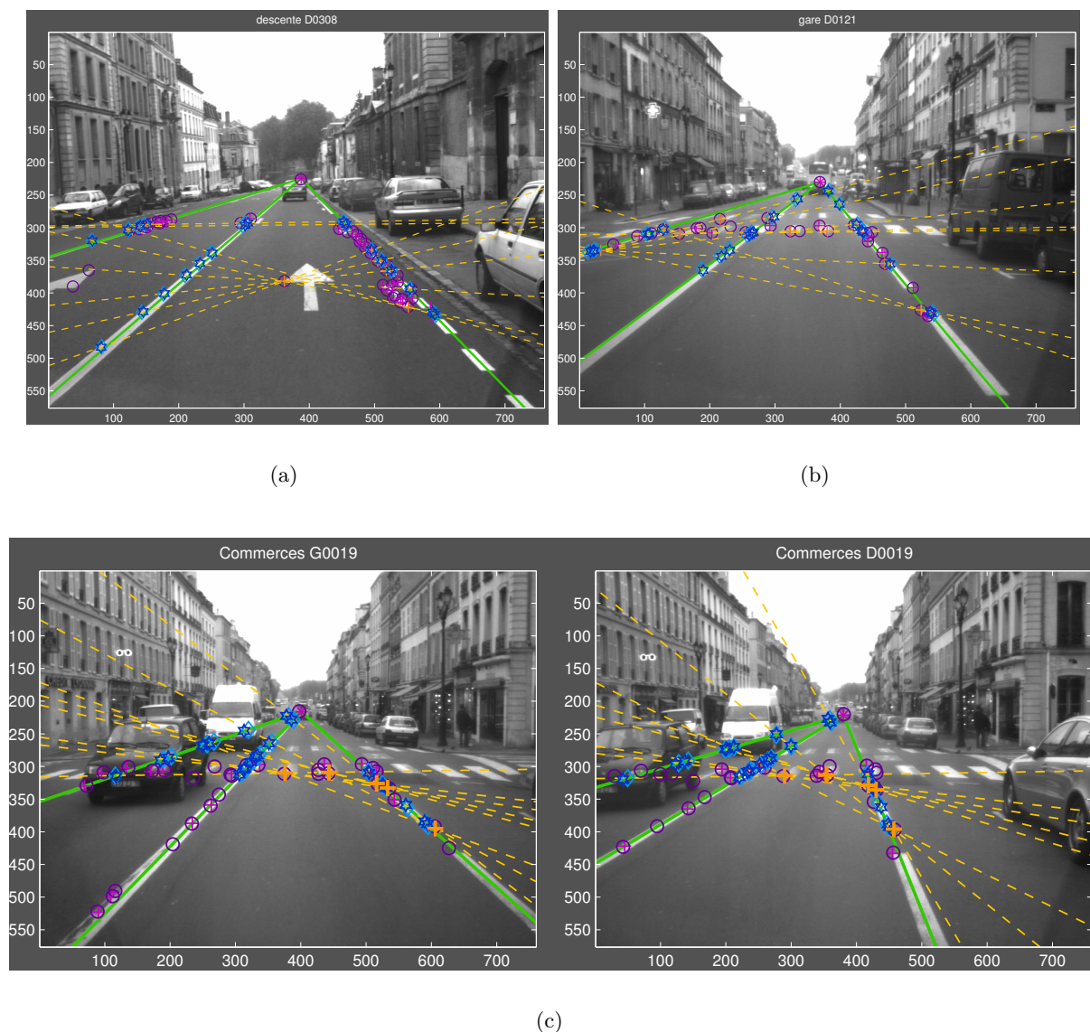
FIG. 6.5 – Cas où la distribution spatiale des SFPs ('+' mauves) n'est pas suffisamment uniforme pour contraindre l'intégralité de la projection du plan de la route. Les droites virtuelles (pointillées oranges) sont formées à partir de SFPs existants dont les projections dans les images courantes ont été identifiées ('+' oranges). L'interception des droites virtuelles avec les médianes des bandes principales (vertes) est à l'origine de VFPs ('◇' bleu-ciels) qui permettent de rigidifier le mouvement apparent de la ROI entre les m images lors du calcul de \mathcal{H} . Les FP et VFP dont les projections vérifient la super-homographie sont respectivement représentés par un 'o violet' et un '◇ bleu foncé'.
