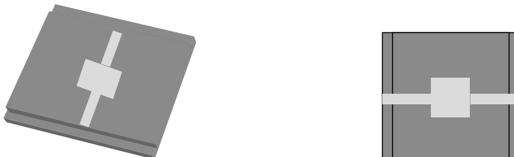
**Figure 3.1** : Visualisation de la cellule EHC (perspective et face) constituée de deux plaques de verre collées en regard l'une de l'autre. La zone gris clair représente l'électrode transparente ITO.
