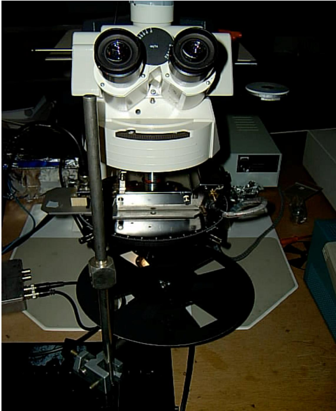
**Figure 6.2** : Dispositifs de mesure et détection du courant pyroélectrique similairement au courant de basculement (**chapitre 4**).
