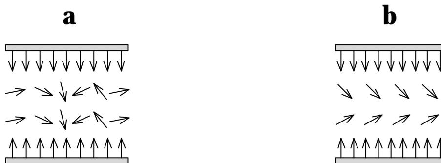
**Figure 5.10** : Structure volumique de type enroulé **(a)** et twisté **(b)**. Les flèches représentent la projection des polarisations moléculaires sur un plan perpendiculaire aux couches smectiques et aux lames de verre.
