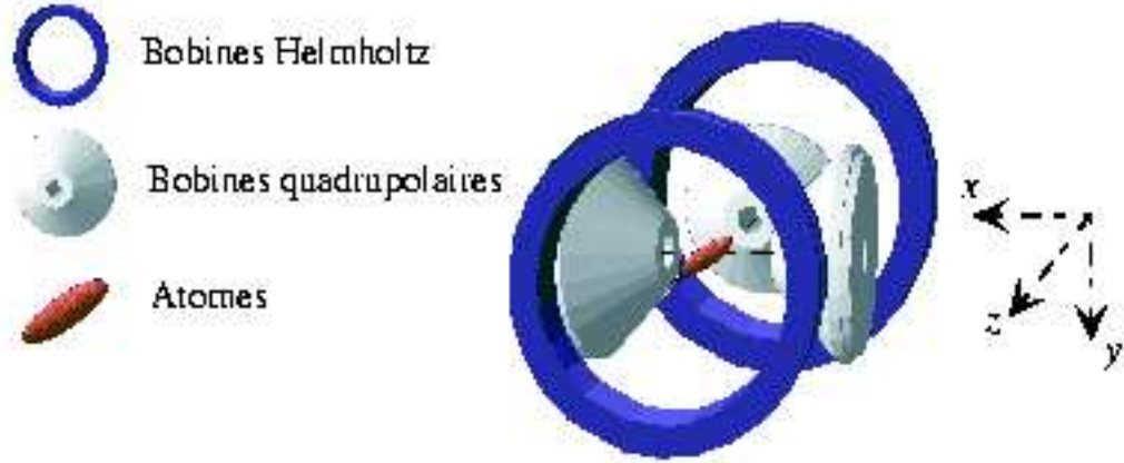
FIG. 2.4 – Géométrie du piège magnétique à trois bobines quadrupolaires et deux bobines Helmholtz. Le piège résultant est allongé selon l'axe des bobines Helmholtz. La raideur verticale du piège est importante pour empêcher les atomes de tomber sous l'effet de la gravité.
