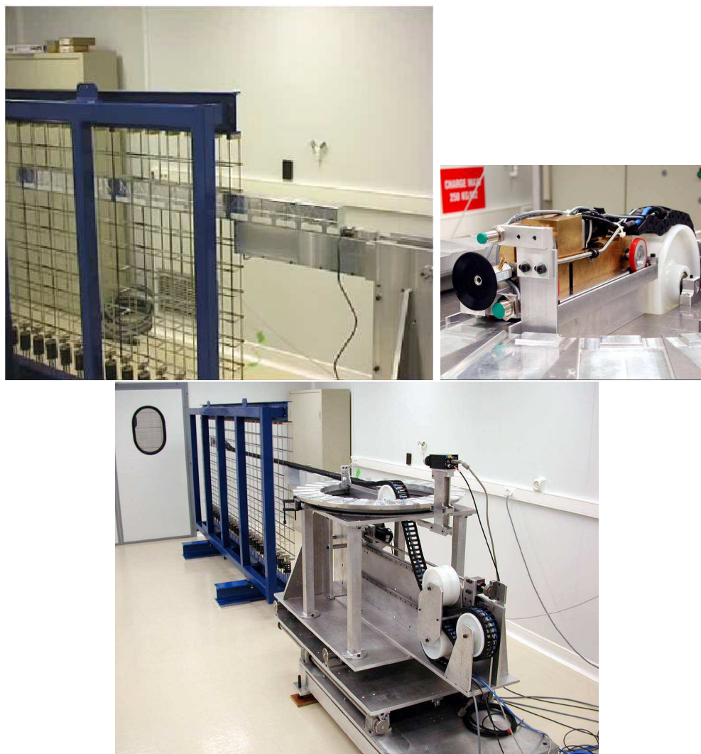
FIG. 4.27 – Photographies du système de manipulation des briques d'OPERA. En haut, à gauche, vue de la structure métallique d'un mur et remplissage d'une rangée de briques ; en haut, à droite, vue du robot avec la ventouse ; en bas, vue d'ensemble.
