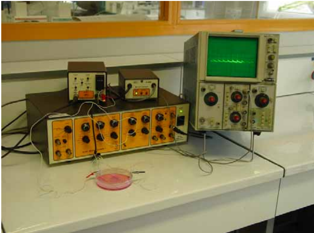
Photo II-2 Montage expérimental d'une boîte de Pétri de 10 centimètres de diamètre pour la stimulation électrique des cellules in vitro . Le support de culture peut être inséré dans un circuit électrique après branchement à un générateur et un isolateur. La stimulation électrique est contrôlée par un oscilloscope pendant la période d'expérimentation.
