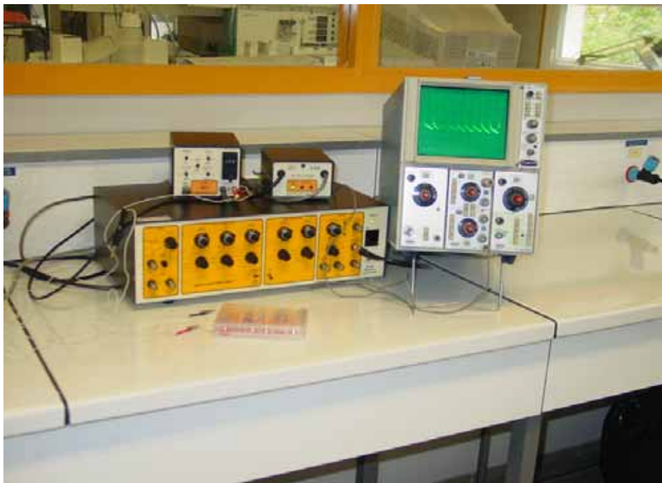
Photo II-1 Montage expérimental en série d'une plaque de 24 puits pour la stimulation électrique des cellules in vitro. Les puits adjacents sont reliés entre eux par des fils de titane. Le support de culture peut être inséré dans un circuit électrique après branchement à un générateur et un isolateur. La stimulation électrique est contrôlée par un oscilloscope pendant la période d'expérimentation.
