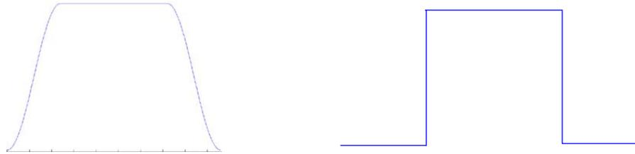
**Figure II-8 :** Enveloppe temporelle en créneaux avec un temps de montée et de descente en forme de demi-fenêtre de Hanning sur la figure de gauche et un temps de montée et de descente très courts sur la figure de droite.
