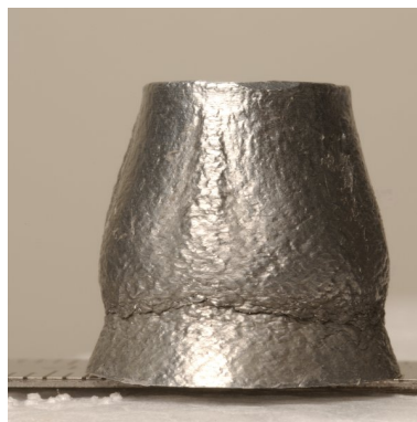
FIG. 2.8 – Essai de Taylor direct pour un projectile en aluminium
