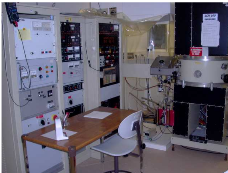
FIG. 3.9: Photo du groupe de pulvérisation cathodique Alcatel SCM 600. Sur la gauche, les baies de contrôle et à droite l'enceinte, le sas et le bras de chargement)
