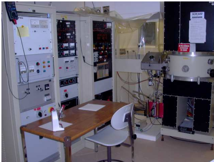
FIG. 3.9: Photo du groupe de pulvérisation cathodique Alcatel SCM 600. Sur la gauche, les baies de contrôle et à droite l'enceinte, le sas et le bras de chargement)
