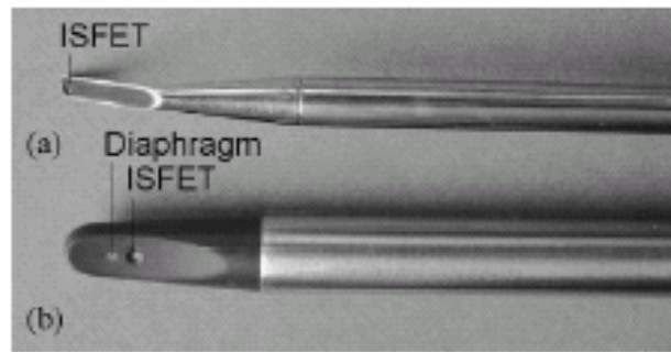
Figure 1.8: ChemFETs encapsulés en utilisant la technique de moulage (réalisés au Meinsberg Kurt-Schwabe Research Institute) pour différentes applications (a, b)
