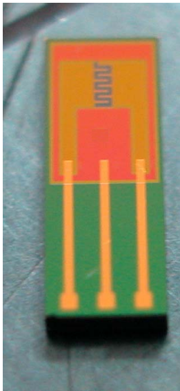
Figure 2.24: Photographie d'un ChemFET (structure "bâtonnet", grille serpentine)
