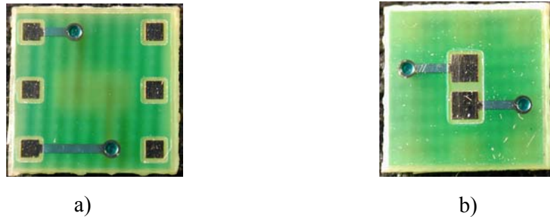
Figure 2.44: Circuit imprimé pour les puces ChemFETs
