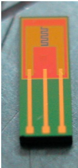
Figure 2.24: Photographie d'un ChemFET (structure "bâtonnet", grille serpentine)
