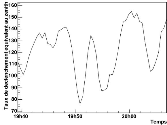
FIG. 15.2: *Evolution du taux de déclenchement au cours d'une acquisition en présence de nuages.* Cette acquisition est la même que pour la figure 7.1(b). Les diminutions du taux de déclenchement signent le passage de nuages dans le champ de vue.
