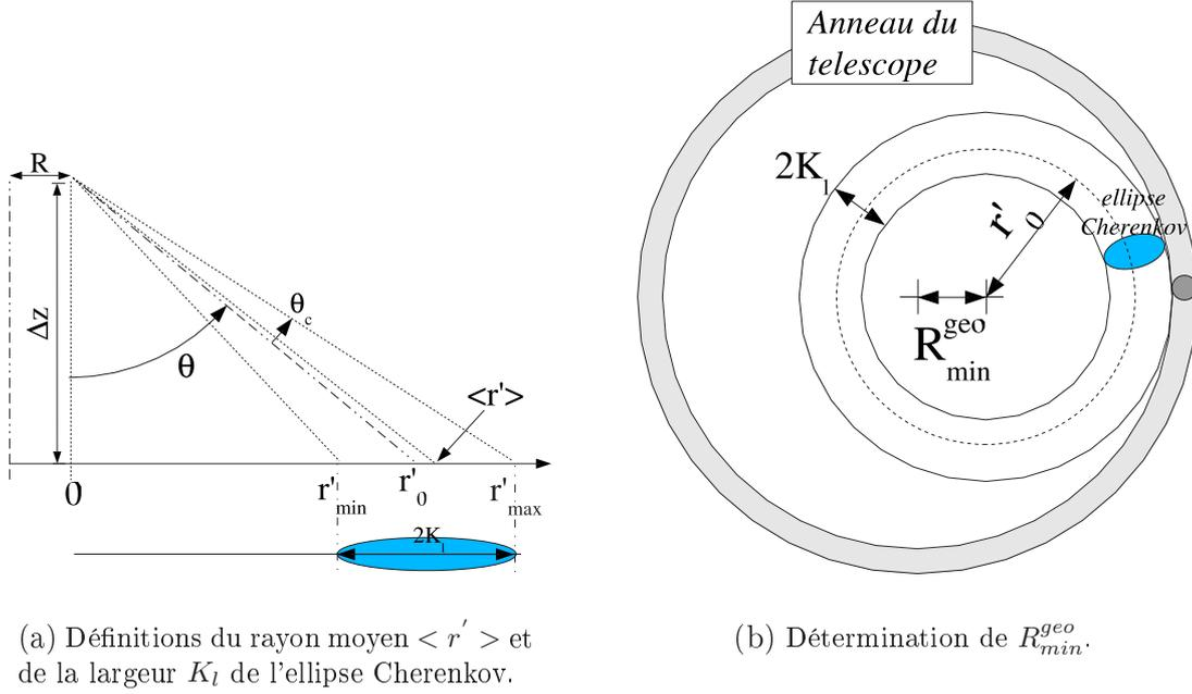
FIG. A.3: Définition des paramètres de l'ellipse Cherenkov et détermination géométrique de la borne inférieure  $R_{min}^{geo}$  d'intégration en distance des  $e^\pm$  à l'axe de la gerbe. (a) L'axe points-tirets indique l'axe de la gerbe. (b) Le paramètre d'impact de la gerbe est au centre de la figure.
