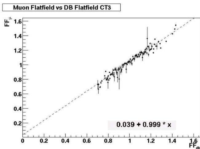
FIG. 12.4: *Corrélation des facteurs de correction d'inhomogénéité obtenus par les muons avec ceux obtenus lors de l'étalonnage classique utilisant une LED pour éclairer les caméras. Le résultat de l'ajustement linéaire est indiqué par une ligne continue. Les pixels situés en bord de caméra sont moins souvent éclairés par les images de muons et les incertitudes sur les coefficients de flat-field sont alors importantes.*
