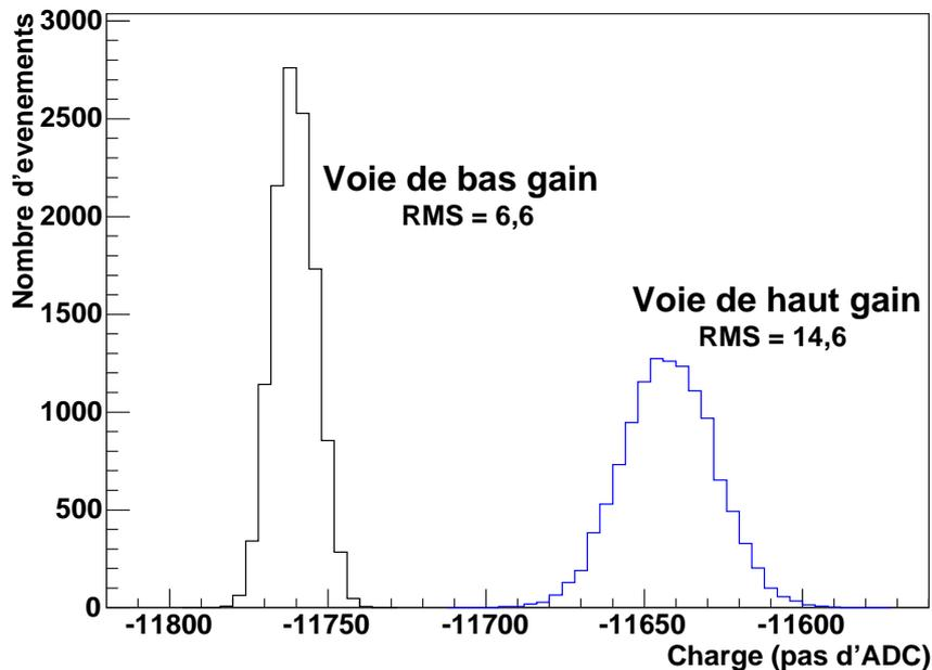
FIG. 8.3: *Piédestaux électroniques.* Distributions des charges en pas d'ADC mesurées dans le noir pour les voies de haut et bas gain d'un pixel : ce sont les piédestaux électroniques de ce pixel. La position indique la ligne de base de la voie d'acquisition et la largeur mesure le bruit électronique.
