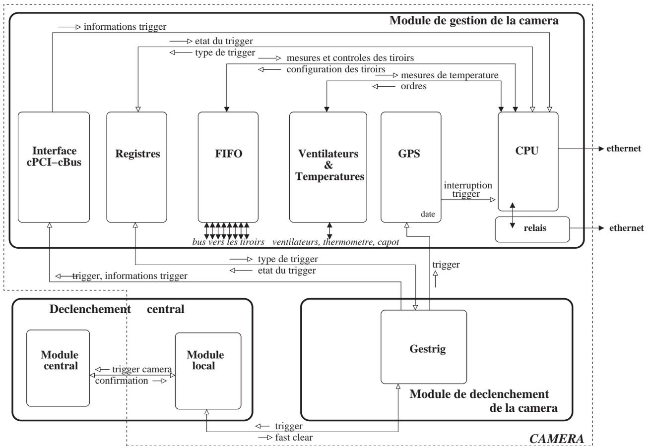
FIG. 5.9: Schéma des principaux échanges réalisés entre les différentes cartes du module de gestion de la caméra. Les échanges avec le module de déclenchement sont aussi indiqués (flèches vides). Ils sont détaillés dans le chapitre 6.
