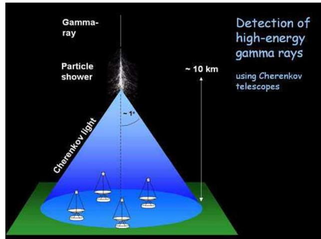
FIG. 2.1: *Principe de l'imagerie Cherenkov atmosphérique. Le  $\gamma$  incident engendre une cascade de particules qui émettent du rayonnement Cherenkov dans un cône dont le rayon au sol est de l'ordre de 120 m. Un imageur, situé dans la tâche de lumière au sol, forme l'image de la cascade dans son plan focal.*
