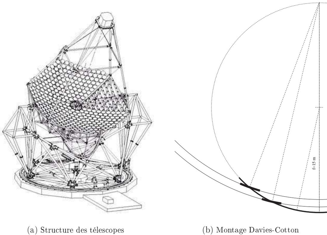
(a) Structure des télescopes
