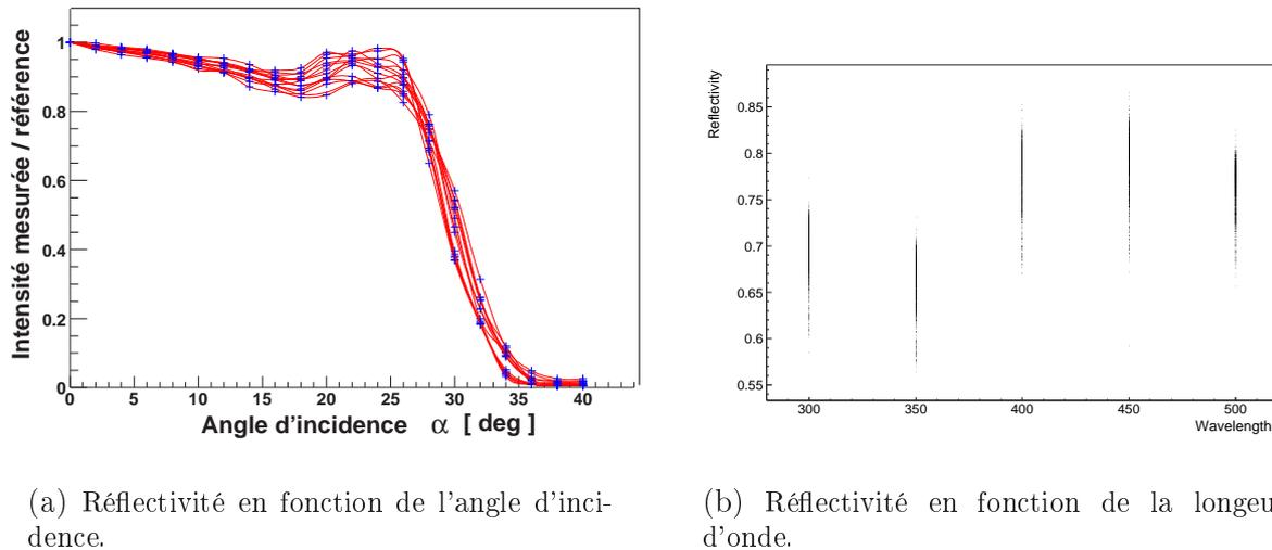
FIG. 5.2: **Réflectivité des cônes de Winston.** (a) Réflectivité moyenne relative en fonction de l'angle d'incidence pour un ensemble de cônes. La lumière arrivant avec un angle d'incidence supérieur à  $30^\circ$  est rejetée à plus de 50%. (b) Réflectivité des cônes de Winston en fonction de la longueur d'onde en nm pour une source de lumière sur l'axe optique.
