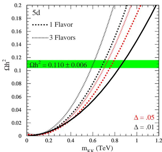
FIG. 18.4: *Densité relicue en fonction de la masse de  $B^{(1)}$ . La ligne continue correspond au calcul de la densité relicue sans coannihilation. Les lignes pointillées indiquent des cas où il y a des coannihilation avec  $e_R^{(1)}$  (courbes noires :  $\Delta = 0,01$ , courbes rouges :  $\Delta = 0,05$ , où  $\Delta$  est la différence relative de masse entre  $B^{(1)}$  et  $e_R^{(1)}$ .) La bande verte indique les contraintes sur la densité relicue.*
