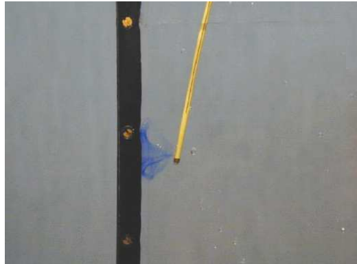
FIG. 2.10 – Cathéter équipé d'hydrojets [Ascari 03].
