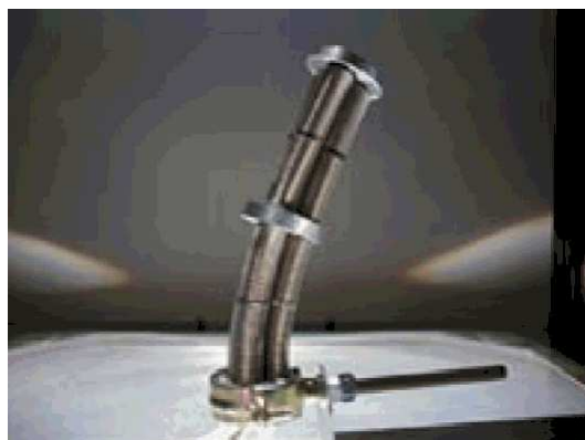
FIG. 2.12 – Endoscope du LAI [Thomann 03b].
