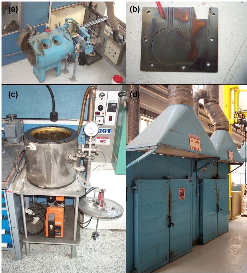
Figure II 5: Mosaïque des principaux éléments pour la réalisation de nos éprouvettes époxy. (a) autoclave permettant la coulée par gravitation à température de 60°C sous vide primaire (b) l'une des deux faces d'un moule à traitement de surface classique employé pour nos éprouvettes (c) enceinte de malaxage des composants et mélanges sous vide primaire et à la température de 60°C (d) four de cuisson à 100°C durant 16h
