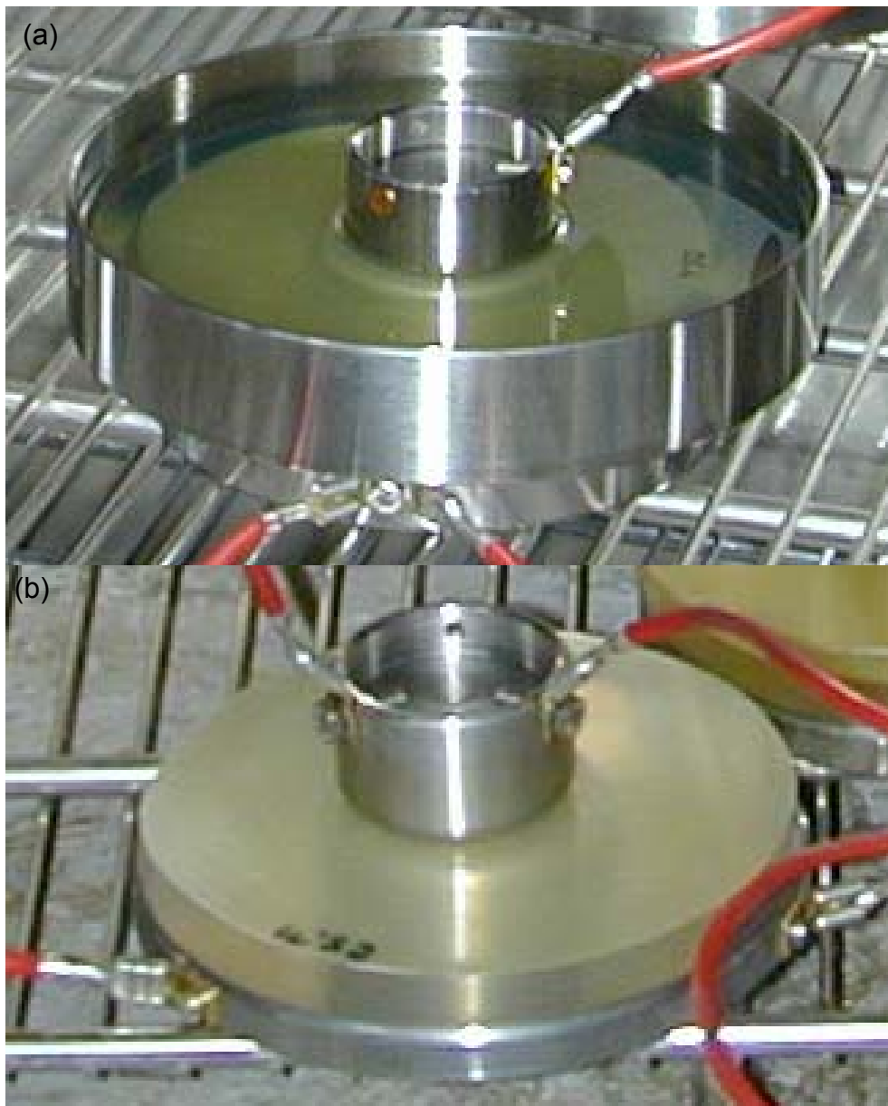
Figure VI 7: Photographie du dispositif de vieillissement électrique (AC) et thermique (72°C) à deux niveaux de champ. (a) 16kV/mm dans l'huile. (b) 2kV/mm à l'air
