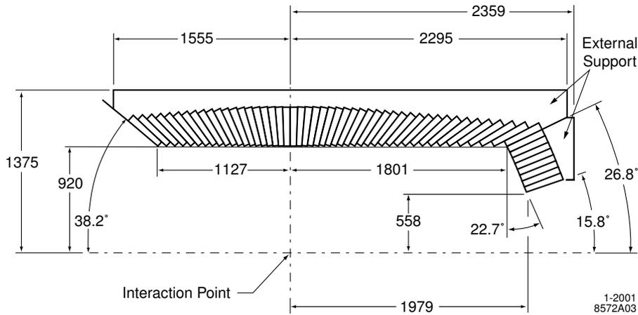
FIG. 3.13 – Section longitudinale de l'EMC. Ce détecteur est de symétrie cylindrique autour de l'axe  $z$ . On distingue deux parties dans l'EMC, la partie bouchon vers l'avant ( $15,8^\circ < \theta < 26,8^\circ$ ) et la partie tonneau, au delà. On compte 56 anneaux de cristaux au total.
