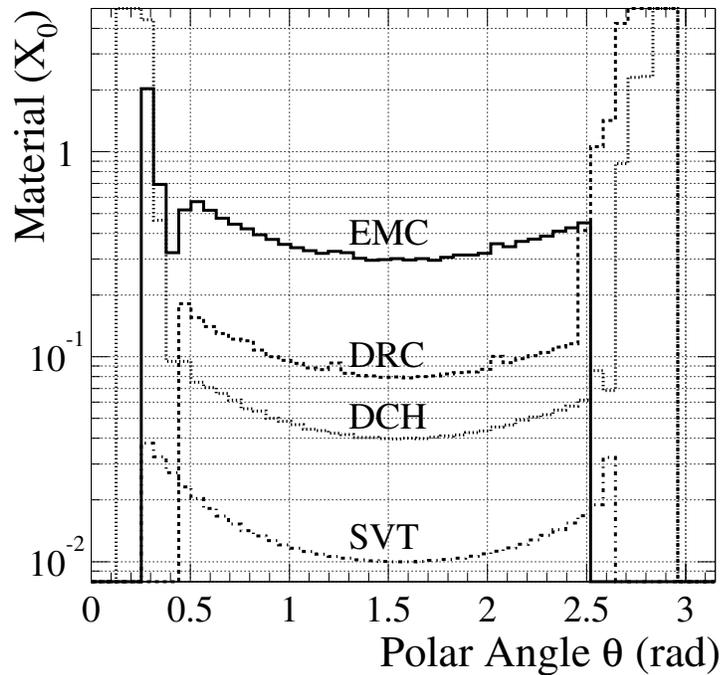
FIG. 3.14 – Fractions de la longueur de radiation pour une particule d'incidence à l'entree du des différents sous-détecteurs.
