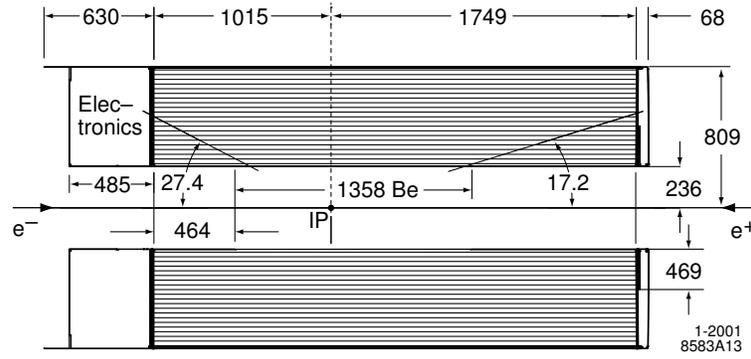
FIG. 3.8 – Section longitudinale de la chambre à dérive [54]
