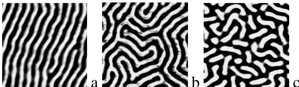
figure 1.1 : images MFM prises en l'absence de champ magnétique sur une couche de 500 nm d'épaisseur. Les différentes images correspondent à un état démagnétisé parallèle (a) et perpendiculaire (b) et à un état rémanent perpendiculaire (c). La taille des images est égale à 5 \mu\text{m} \times 5 \mu\text{m} . Les contrastes noir et blanc correspondent à des domaines d'aimantation alternée.
