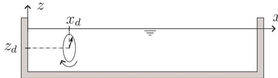
FIG. I.3.1 – Position du doublet tournant dans le bassin
