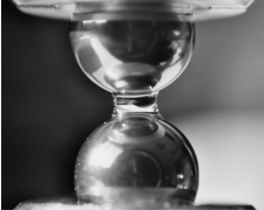
FIG. 2.13 – Photographie d’un doublet capillaire.
