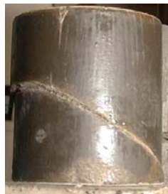
Photo IV-9: Echantillon BC18: essai d'extension sous p'_0=2 MPa
