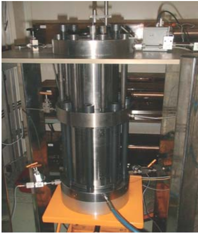
Photo II-1: Cellule triaxiale autonome et générateur de pression de fluide.
