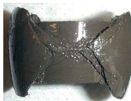
Photo IV-5 : Échantillon d'argile de Boom après un essai de cisaillement jusqu'à un niveau de déformation très important (essai BC06).
