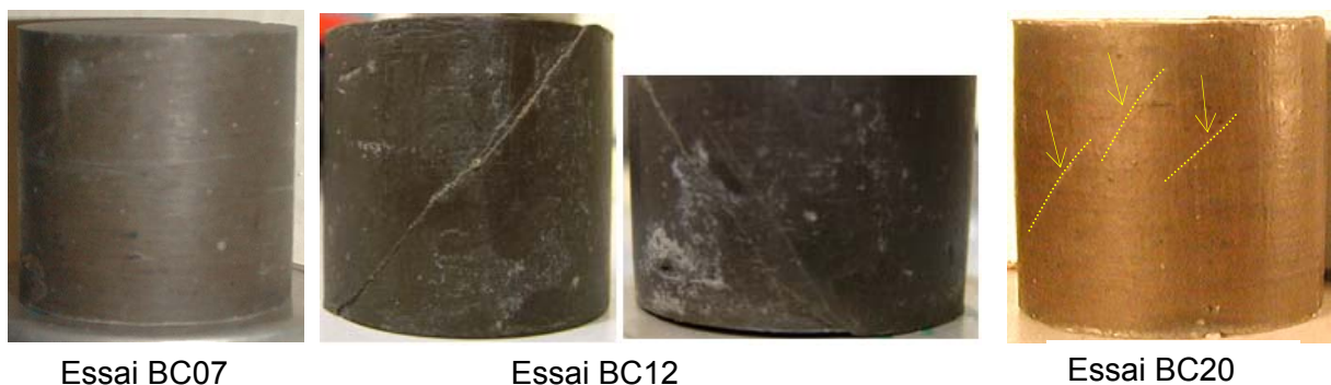
Photo IV-7: Échantillons cisailés sous une contrainte effective isotrope de 2,3 MPa : observation d'une rupture non localisée (BC07) et localisée (BC12 et BC20).
