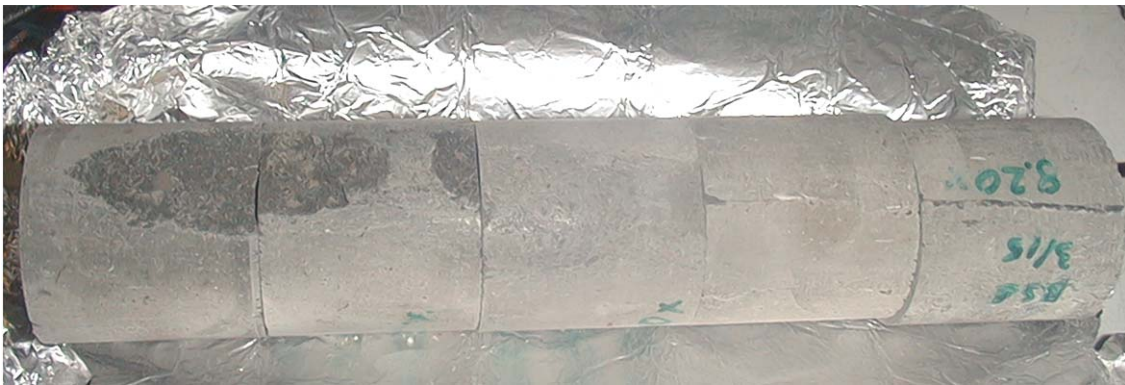
Photo V-2: Échantillons d'argile à Opalinus avant les essais de compression triaxiale : observation de fissures et de zones arrachées.
