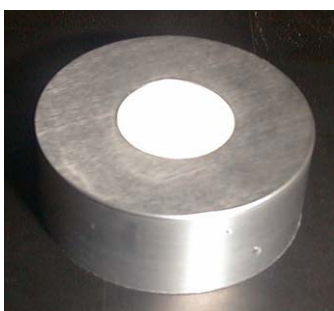
Photo III-1: Céramique poreuse à haute entrée d'air insérée dans un disque en acier inoxydable de 40 mm de diamètre et de 15 mm de hauteur.
