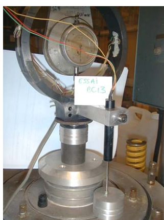
Photo IV-1: Dispositif expérimental pour les essais de compression simple.
