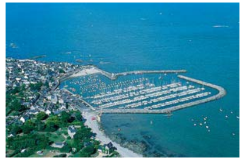
Figure 45 : Port de Piriac après les travaux de 1996 – 97 Bassin à flot + port d'échouage Superficie du plan d'eau : environ 8,5 ha Nombre de bateaux de pêche professionnelle : 7 Nombre de bateaux de plaisance : 620 Places disponibles : 640 (500 à flot + 140 échouage)
