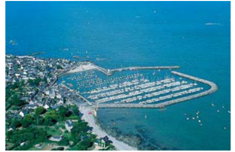
Figure 45 : Port de Piriac après les travaux de 1996 – 97 Bassin à flot + port d'échouage Superficie du plan d'eau : environ 8,5 ha Nombre de bateaux de pêche professionnelle : 7 Nombre de bateaux de plaisance : 620 Places disponibles : 640 (500 à flot + 140 échouage)
