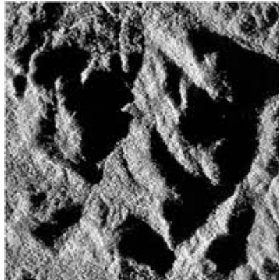
Figure 5 : Zones d'ombre sur une image radar (parties foncées). Le radar visait de gauche à droite.
