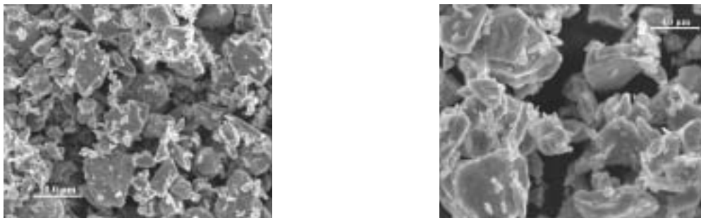
Figure II.26 : Micrographie obtenue par MEB des poudres obtenues par hydruration-deshydruration.
