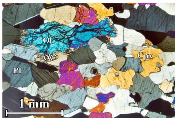
FIG. 2.51 – Gabbronorite à olivine à texture d'adcumulat (massif de Suma'il, échantillon 95 M 168b). Lumière polarisée, nicols croisés.
