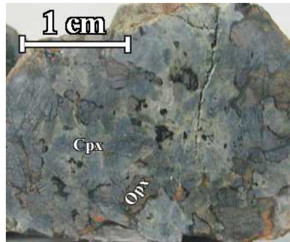
FIG. 2.100 – Face sciée d'un échantillon de webstérite à gros grains, le caractère sub-automorphe de l'orthopyroxène est déjà visible (massif de Suma'il, échantillon 97 M 39).
