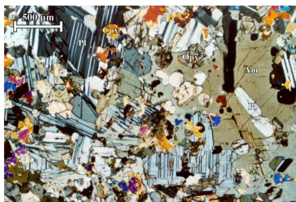
FIG. 2.71 – Échantillon de gabbro-norite à amphibole, l'hornblende apparaît en plages pœcilitiques (échantillon 00 NA 50). Lumière polarisée, nicols croisés.
