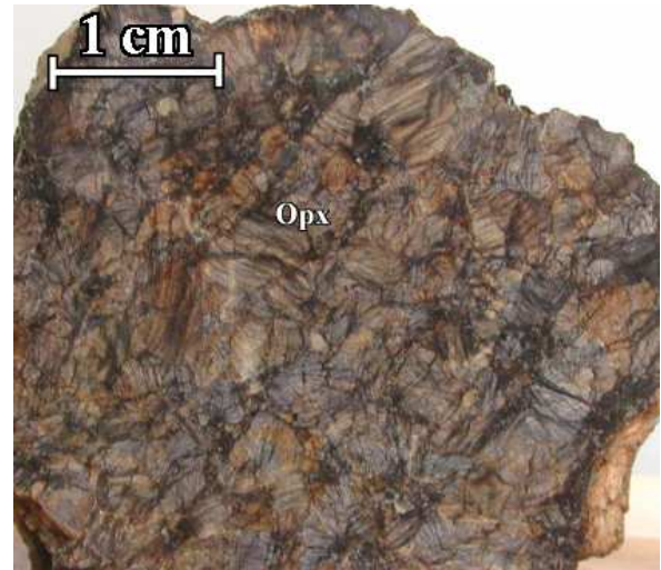
FIG. 2.94 – Face sciée d'un échantillon d'orthopyroxénite à gros grains (massif de Nakhil, échantillon 00 NA 61).
