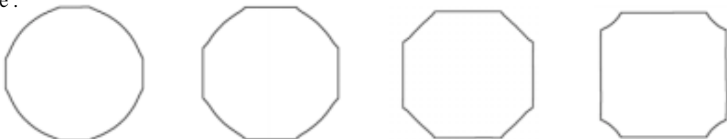
Figure IV-17 : Comparaison entre l'angle de contact relatif au caractère libre ou contraint du frittage, en fonction du nombre de boucles Monte Carlo. Jusqu'à 60 000 boucles l'évolution des cous est identique pour les deux systèmes alors que les angles de contact sont différents.
