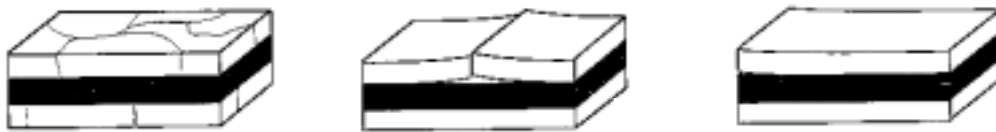
Figure I-6 : Types de défauts principaux générés lors du frittage contraint : fissuration, délaminage et décohéation [16].
