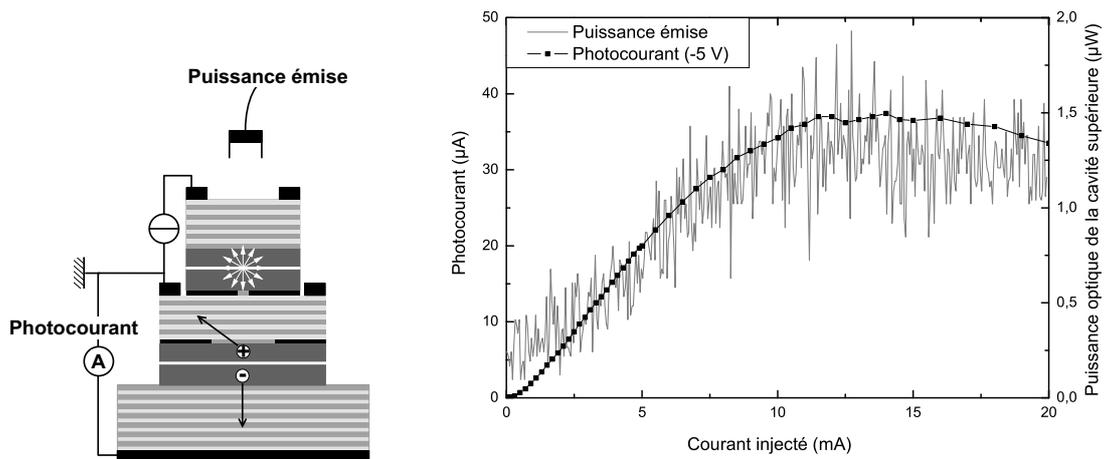
**Figure 3.32.** Photocourant détecté par la cavité inférieure. Comparaison avec la puissance émise par la cavité supérieure.
