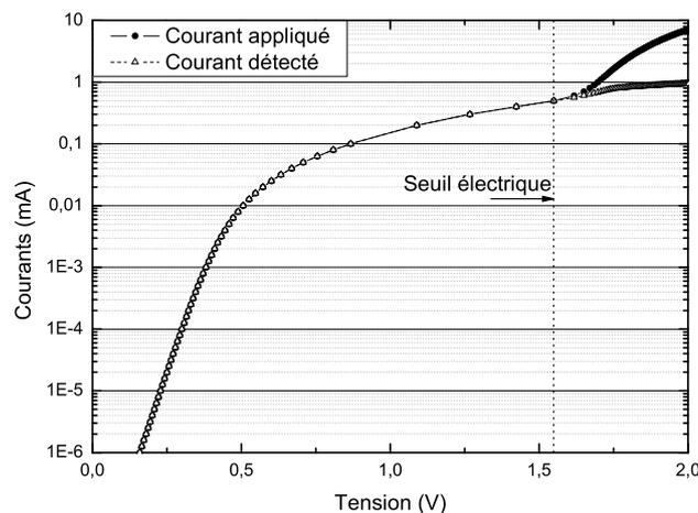
**Figure 4.23.** Extraction du seuil électrique :  $I_A(V_A)$  et  $I_D(V_A)$ .
