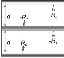
Le comportement des cavités couplées est décrit de façon simple [111] par un système comportant deux cavités simples identiques accolées. Les deux modes sont obtenus en exprimant la transmission de la structure en fonction des coefficients de réflexion de chaque miroir. Pour une structure dont les réflectivités des miroirs sont  $R_0$ ,  $R_1$  et  $R_0$  (figure ci-contre) et l'épaisseur de la cavité est  $d$ , la transmission est telle que [111] :
