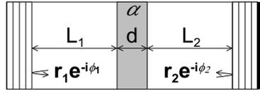
**Figure 3.8.** Schéma de la structure modélisée. Les grandeurs entrant en jeu dans le calcul sont représentées.  $r_1$  et  $r_2$  sont les coefficients de réflexion en amplitude,  $R_1$  et  $R_2$  en intensité.
