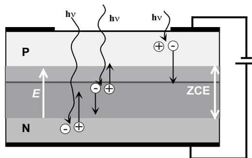
Figure 1.6. Photoporteurs générés dans la photodiode.
