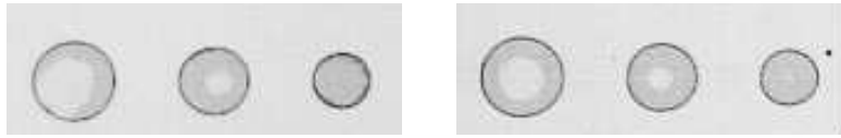
Figure 2.17. Stabilisation du four. À gauche : attente de 2 h (très long); à droite : pas d'attente. La désoxydation est à base de HCl. Les dimensions sont 40, 34 et 28 \mu\text{m} .
