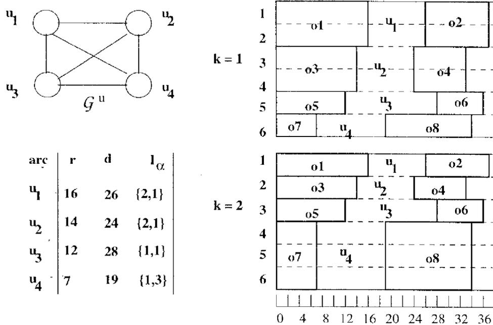
FIG. III.14 - Clique d'occupation maximale sur deux ressources
