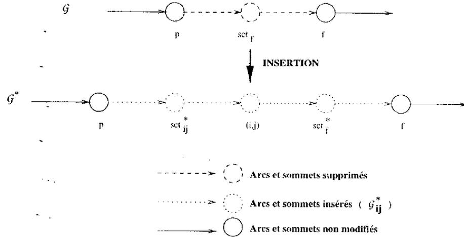
FIG. III.21 – Modifications dans  $\mathcal{G}$  dues à l'insertion sur des ressources associées
