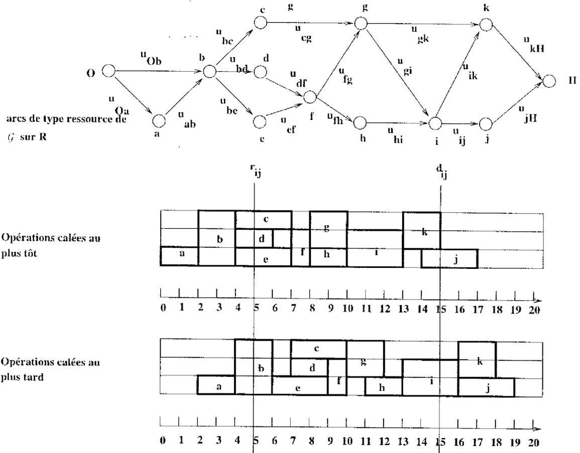
FIG. III.18 Exemple d'ordonnancement sur une ressource cumulative
