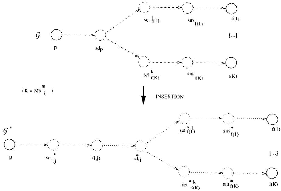
FIG. III.23 – Modifications dans  $\mathcal{G}$  dues à l'insertion à la fin d'une association
