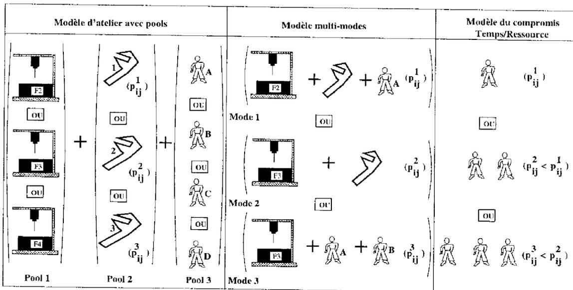
FIG. II.2 – Trois modèles pour la flexibilité multi-ressources
