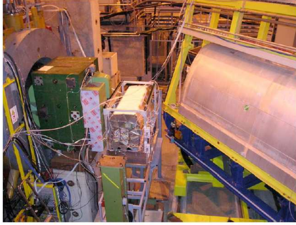
FIG. 3.16 – Prise de vue du test en faisceau combiné 2004 dans la zone H8 (Tonneau). Le faisceau arrive par la gauche. Sont visibles le détecteur à pixels au centre et le calorimètre électromagnétique dans son cryostat à droite
