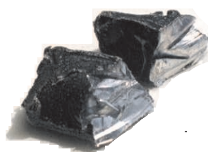
FIG. A.1 – Photographie d'un échantillon de lithium métallique. L'échantillon, stocké dans l'air du laboratoire, est partiellement recouvert d'une couche d'oxydes et de carbonates.
