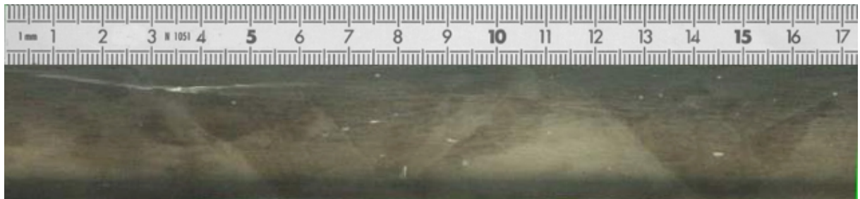
Figure G-7 : \text{CH}_4+2(\text{O}_2+\beta\text{N}_2) , P_0=0,5\text{bar} , T_0=600\text{K} et \beta=1
