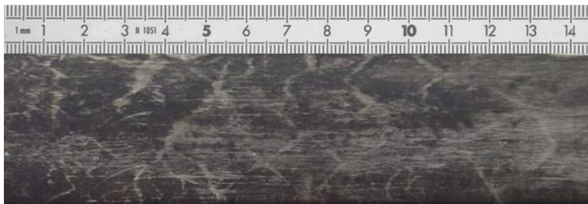
Figure G-30 : x\text{H}_2+(1-x)\text{CH}_4+(2-1,5x)(\text{O}_2+\beta\text{N}_2) , x=0,25 ; P_0=0,4\text{bar} , T_0=473\text{K} et \beta=0
