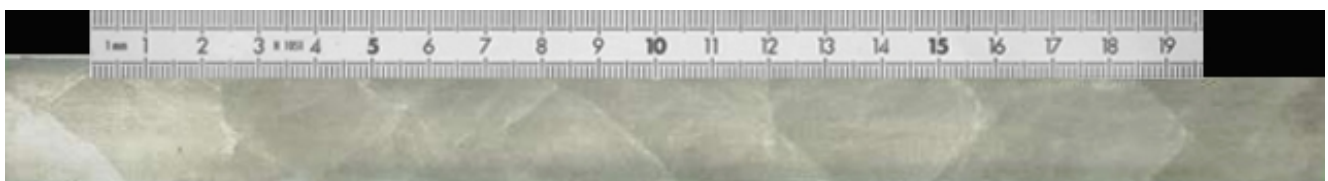
Figure G-28 : x\text{C}_2\text{H}_6+(1-x)\text{CH}_4+(2+1,5x)(\text{O}_2+\beta\text{N}_2) , x=0,6 , P_0=2\text{bar} , T_0=500\text{K} et \beta=3,76
