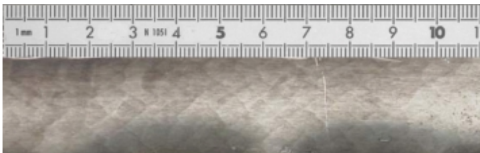
Figure G-22 : H_2+0,5(O_2+\beta N_2) , P_0=1,5\text{bar} , T_0=473\text{K} et \beta=3,76
