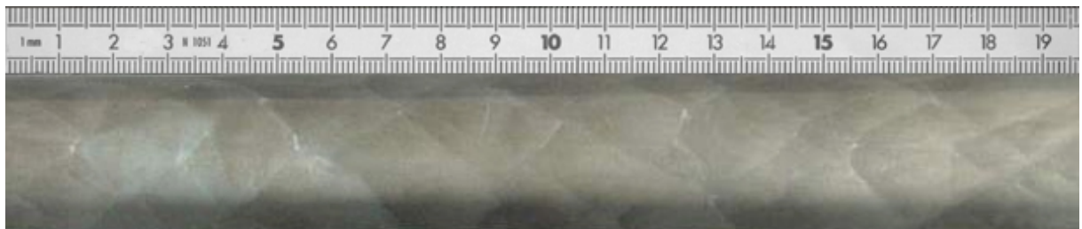
Figure G-8 : \text{CH}_4+2(\text{O}_2+\beta\text{N}_2) , P_0=2\text{bar} , T_0=293\text{K} et \beta=2
