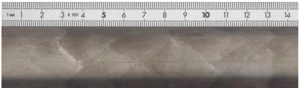
Figure G-9 : \text{CH}_4+2(\text{O}_2+\beta\text{N}_2) , P_0=2\text{bar} , T_0=600\text{K} et \beta=2
