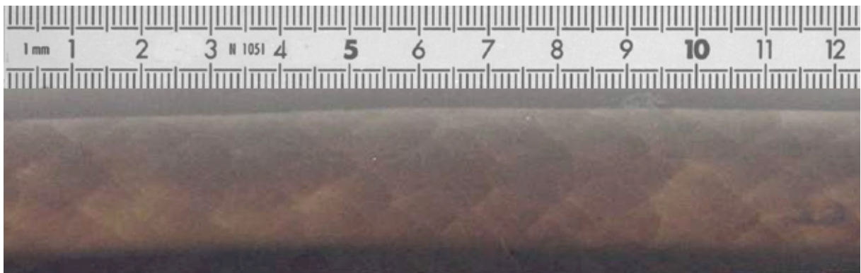
Figure G-33 : x\text{H}_2+(1-x)\text{CH}_4+(2-1,5x)(\text{O}_2+\beta\text{N}_2) , x=0,5 ; P_0=1\text{bar} , T_0=293\text{K} et \beta=2
