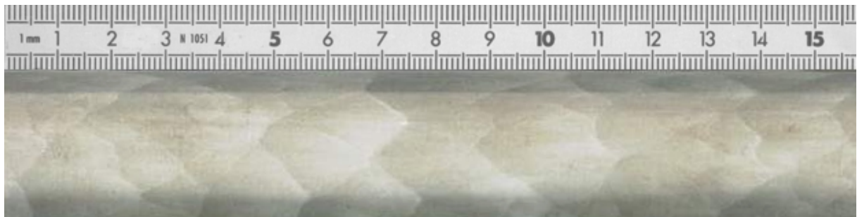
Figure G-37 : x\text{H}_2+(1-x)\text{CH}_4+(2-1,5x)(\text{O}_2+\beta\text{N}_2) , x=0,75 ; P_0=0,7\text{bar} , T_0=473\text{K} et \beta=2
