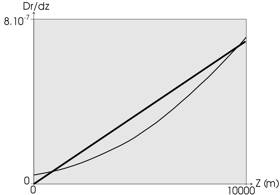
Fig. 11.31 – Quantité d'eau condensée par unité d'ascension en fonction de l'altitude, et relation linéaire utilisée dans le modèle
