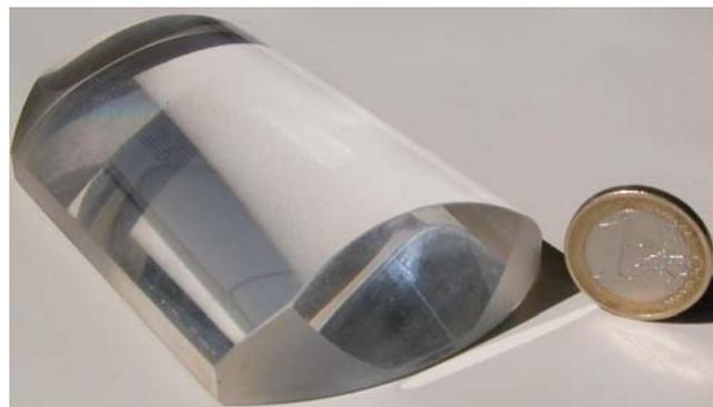
Figure 5.6 : photo d'une lentille en quartz de MF1
