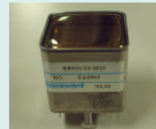
Photomultiplicateur multi-anodes (4*4, 6*6 ou 8*8)
