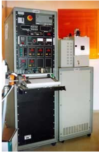
Figure 4.6 : Bâti deRIE à gaz fluoré Plassys (salle blanche de l'IMFC)
