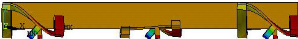
Figure 5.7 : schéma de la structure du microrobot vu de côté lorsque trois pattes sont actionnées
