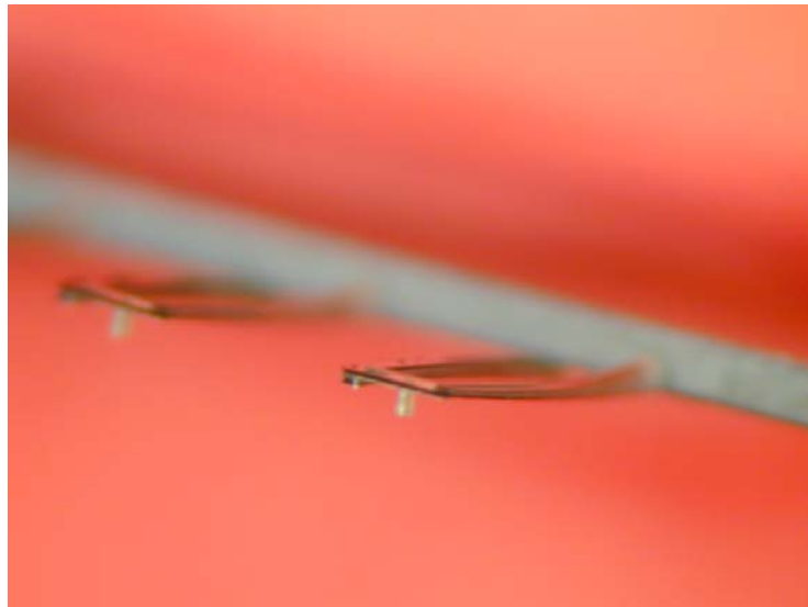
Figure 4.13 : Micropattes en résine SU-8 sur silicium avec les actionneurs en opposition et la liaison de 20 \mu\text{m} Le procédé de fabrication que nous avons établi pour ces réalisations est donné en annexe 11.
