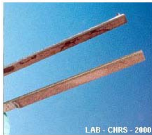
Figure 2.31 : photo des actionneurs piézo-électriques réalisés à l'IMM : unimorphe en haut et bimorphe en bas
