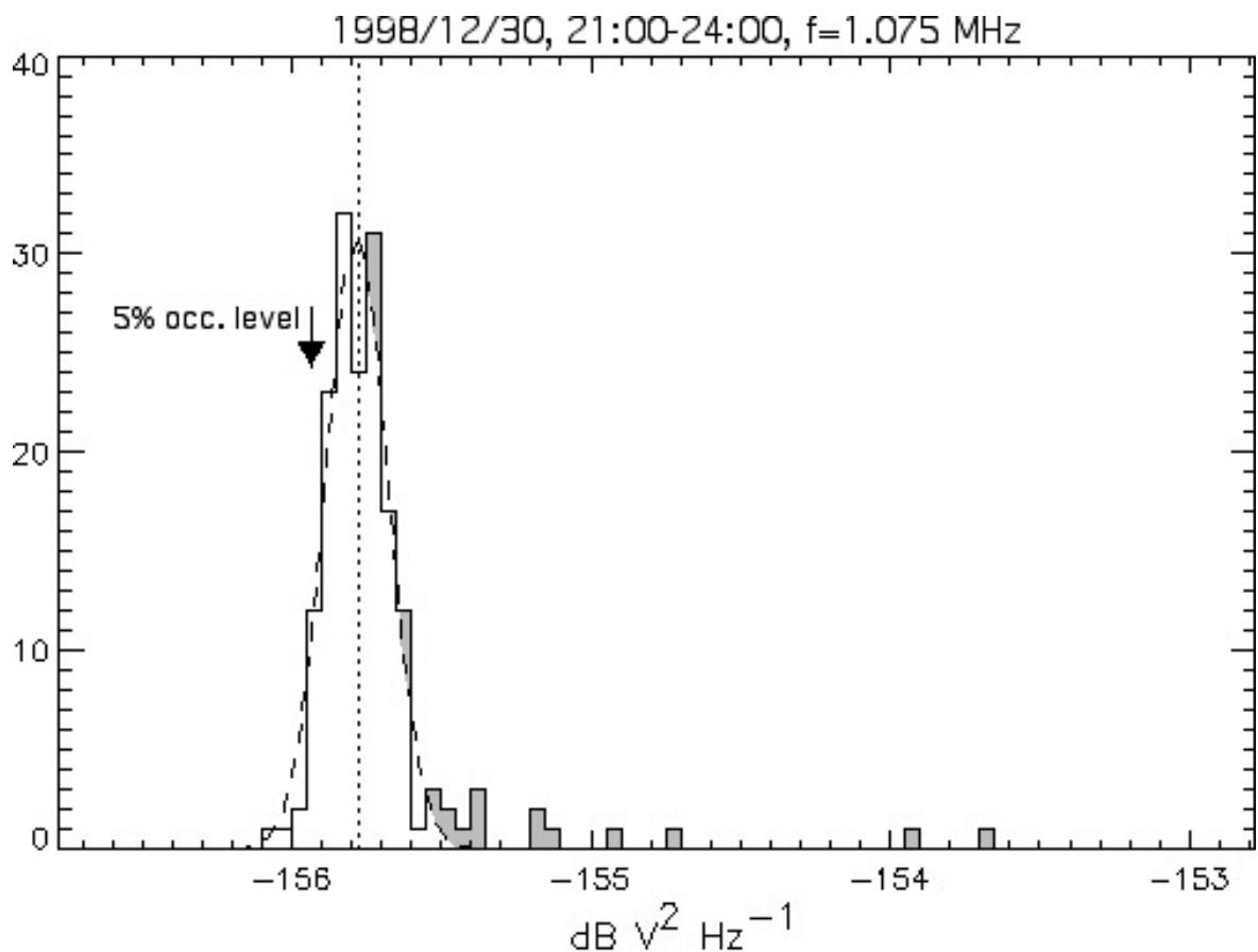
FIG. 4.6 – Histogramme des intensités sur des échantillons de 60s tirés du spectres de la figure 4.5, à la fréquence de 1.075 MHz. La courbe en tirets est la gaussienne du bruit de fond dont la valeur centrale (ligne pointillée verticale) correspond au niveau  $P_g + P_r$ . Les zones grisées correspondent aux émissions solaires de type III que l'on peut voir sur la figure 4.5. [Figure tirée de Zarka et al., 2004]
