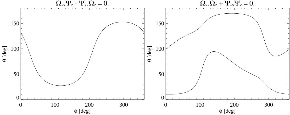
FIG. 3.6 – À gauche : Lieu des points où  $\Omega_{+x}\Psi_z - \Psi_{+x}\Omega_z = 0$ . À droite : Lieu des points où  $\Omega_{+x}\Omega_z + \Psi_{+x}\Psi_z = 0$ . Les coordonnées  $\theta$  et  $\phi$  sont les colatitudes et azimuts dans le repère du satellite. Ces courbes correspondent aux indéterminations numériques dans le cas général de l'inversion goniopolarimétrique analytique.
