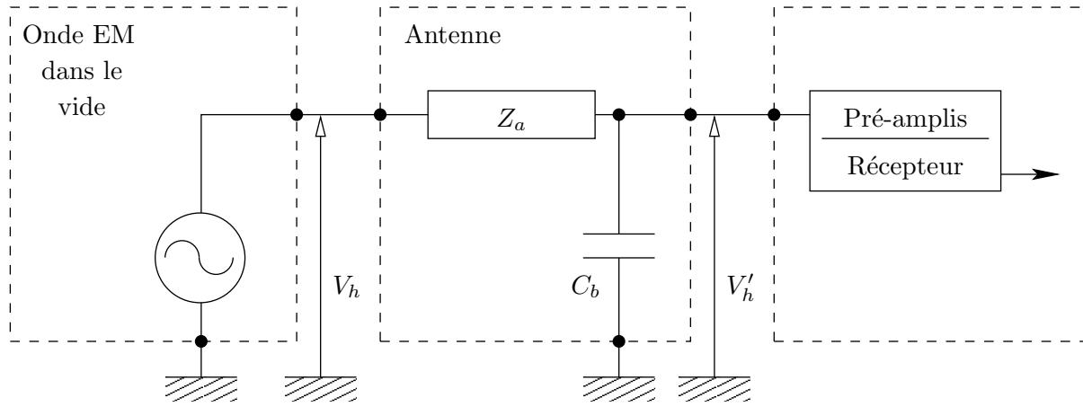
FIG. 2.2 – Circuit électrique équivalent d'une antenne. La tension  $V_h$  est la tension mesurée aux bornes de l'antenne à vide.  $Z_a$  est l'impédance d'entrée de l'antenne.  $C_b$  est la capacité de base.  $V'_h$  est la tension mesurée par le récepteur.
