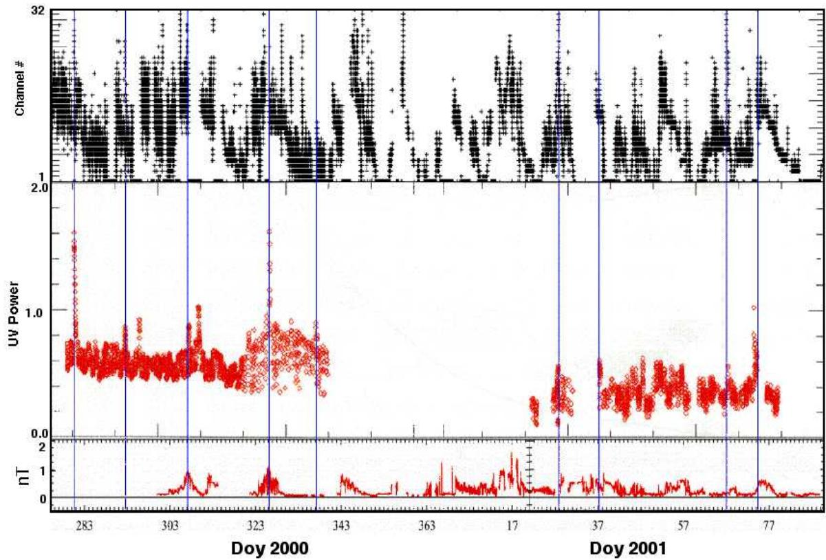
FIG. 5.9 – Comparaison de l'intensité du champ magnétique du vent solaire mesuré par Cassini (en bas), de la puissance totale rayonnée en TW par les aurores en UV (caméra UVIS de Cassini) et fréquence centrale de la bande d'émissions des sursauts QP et de leur queues (données RPWS/HFR en numéro de canal des bandes ABC). Les traits bleus verticaux indiquent les événements intenses que l'on observe en UV, en radio et parfois sur le champ magnétique.
