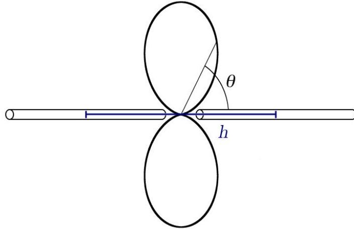
FIG. 2.1 – Diagramme de réception d'un dipôle court. Le gain d'un dipôle court varie en  $\sin^2 \theta$  où  $\theta$  est l'inclinaison du vecteur d'onde incident par rapport à la direction de l'antenne. La longueur du dipôle est la distance  $h$  reliant les centres des deux brins.
