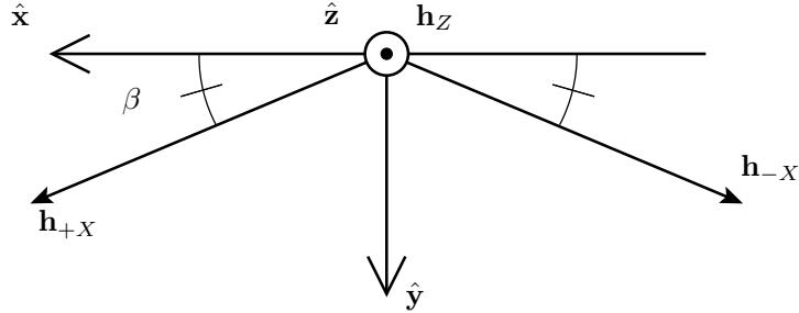
FIG. 3.4 – Le repère des antennes. L'axe  $\hat{\mathbf{z}}$  est selon la direction de l'antenne Z.  $\hat{\mathbf{x}}$  et  $\hat{\mathbf{y}}$  sont choisis tels que les antennes  $+X$  et  $-X$  aient des azimuts supplémentaires. En général, les antennes  $+X$  et  $-X$  n'ont pas les mêmes colatitudes.
