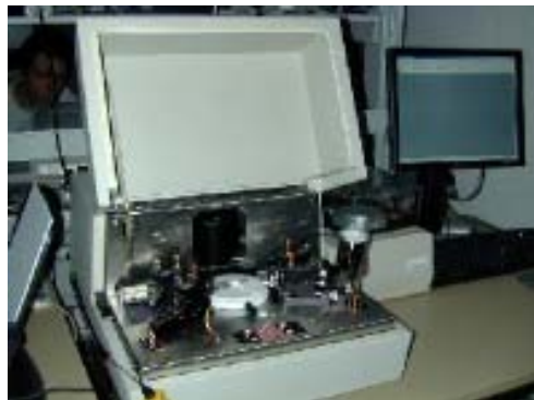
Figure III-8 : Banc de mesure par effet Hall.
