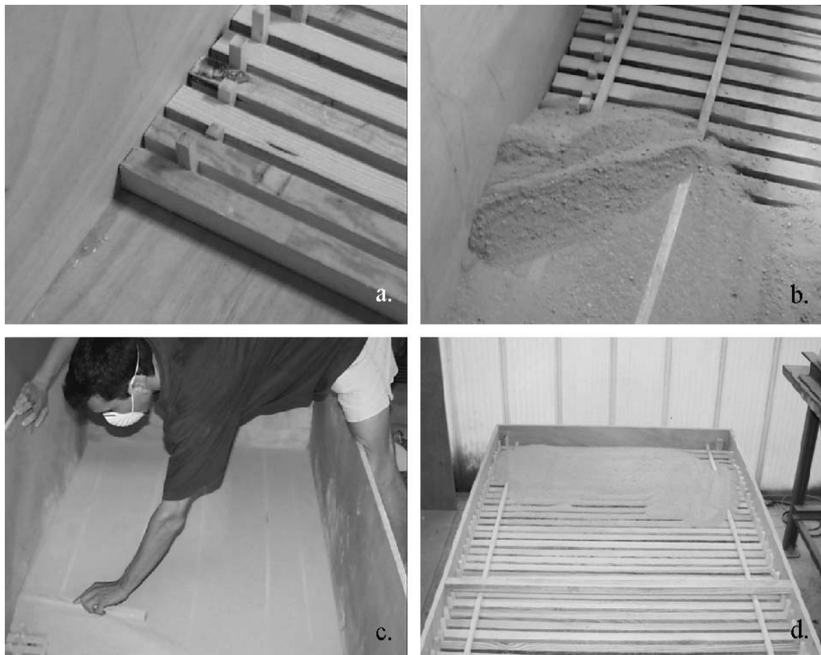
Figure 4-2. Construction du modèle réduit. (a) Début du remplissage de la caisse: mise en place de la première couche de tasseaux. (b) Remplissage des espaces inter-inclusions par le sable limoneux. (c) La couche intercalaire de sable limoneux, d'épaisseur 13 mm, est mise en place à épaisseur constante, sans compactage. (d) Mise en place de la 12 ème (et dernière) couche.
