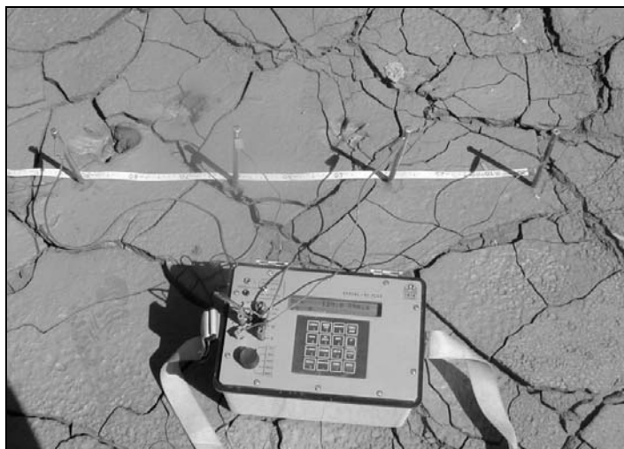
Figure 5-20. Photographie du dispositif mis en place pour mesurer la résistivité de la matrice silto-argileuse. L'espace des électrodes est égal à 20 cm; les craquelures visibles à la surface du sol sont peu profondes (de l'ordre de 1 à 2 centimètres).
