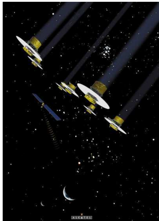
FIG. 1.10 – Gauche : Vue d'artiste de la mission DARWIN telle que conçu par Alcatel Space. On distingue les 6 télescopes, la station de recombinaison au centre et la station de pilotage. Droite : Spectres en émission du Soleil et des principales planètes de notre système solaire (en haut). Spectre simulé de la planète Terre tel qu'il serait obtenu avec la mission Darwin depuis une distance de 30 années lumières (en bas). Les trois raies en absorption sont caractéristiques de l'activité biologique terrestre.
