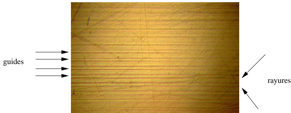
FIG. 5.14 – Exemples de guides droits réalisés par photo-exposition dans un verre d' \text{As}_2\text{S}_3 . Les guides sont les structures horizontales. Les traits fins obliques sont des rayures à la surface du verre.
