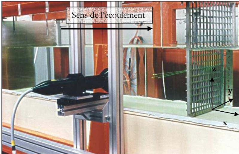
Figure 2.6. : Ensemble du dispositif nid d'abeilles et grille
