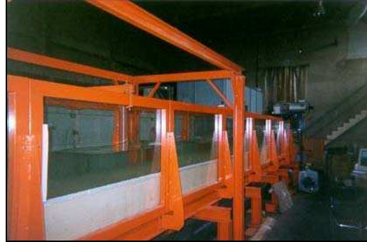
Figure 2.1.b. : Canal à houle et/ou courant
