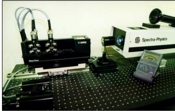
Figure 2.13. : Système laser avec mesureur de puissance
