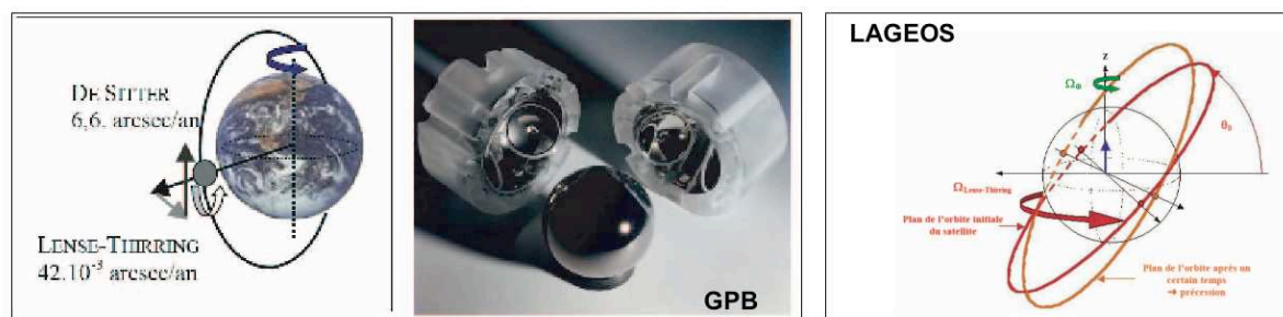
Fig. 6.3 : A gauche, le projet Gravity Probe B dont le but est de mettre en évidence un mouvement de précession de l'axe des gyroscopes proportionnel à la valeur moyenne de l'effet Lense-Thirring et de l'effet de Sitter sur toute la trajectoire du satellite. Le gyroscope mécanique est constitué d'un rotor - une sphère en quartz de 3,8 cm de diamètre recouverte de Niobium supraconducteur - en suspension électrostatique. À droite, le projet LAGEOS qui étudie la précession de plan de l'orbite d'un satellite soumis à l'effet Lense-Thirring
