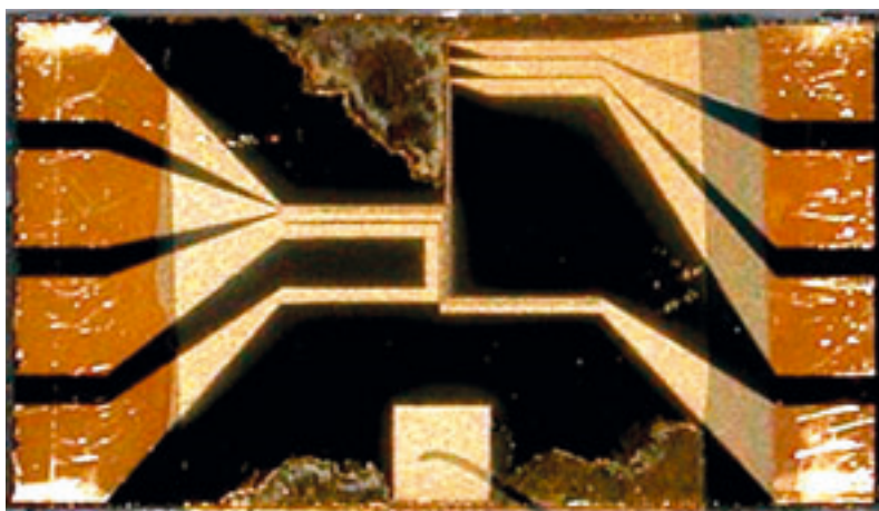
CETTE « PUCE À ATOMES », d'une surface de 1 cm 2 , permet de fabriquer et de guider les condensats, ouvrant la voie à la miniaturisation des lasers à atomes.
