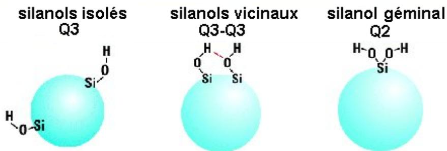
**Figure 7 : Différents types de silanols présents à la surface de la silice**
