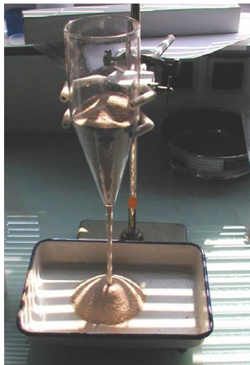
Figure 6-7 : Essai d'écoulement d'une poudre 100-500 \mu\text{m}
