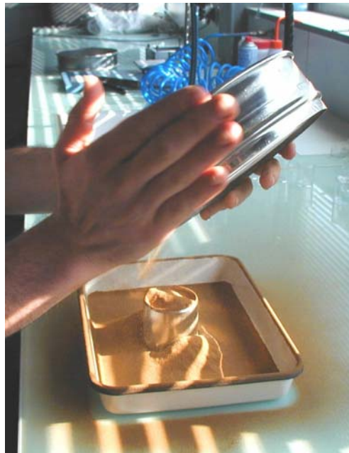
Figure 6-8 : Essai de mesure de la densité apparente sur une poudre sèche
