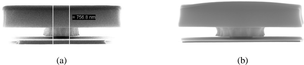
FIG. 3.21: (a) Forte réduction de la dimension de base causée par les gravure et sous-gravure chimiques des couches d'arséniures. (b) Amélioration du procédé par inversion de l'ordre des gravures chimiques.
