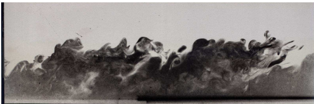
FIG. 7.1 – Vue instantanée d'une couche limite : visualisation d'une frontière intermittente (Falco (1997))
